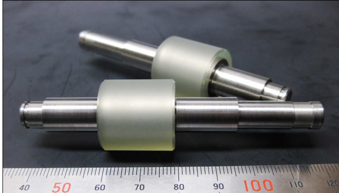
製品番号: SS12U21253ENS 使用用途: Dシャフト ローラー寸法 長:20 径:φ20 硬度: 90エステル シャフト寸法 長:84 径:φ①14 ②10 ③8
