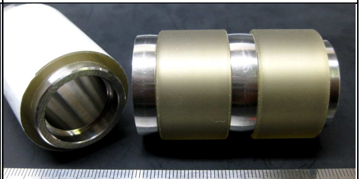
製品番号: SS12U80451LNS 使用用途: ローラ ローラー寸法 長:40 径:φ32 硬度: 35エステル シャフト寸法 長:53.25 径:φ①30 ②26 ③19
