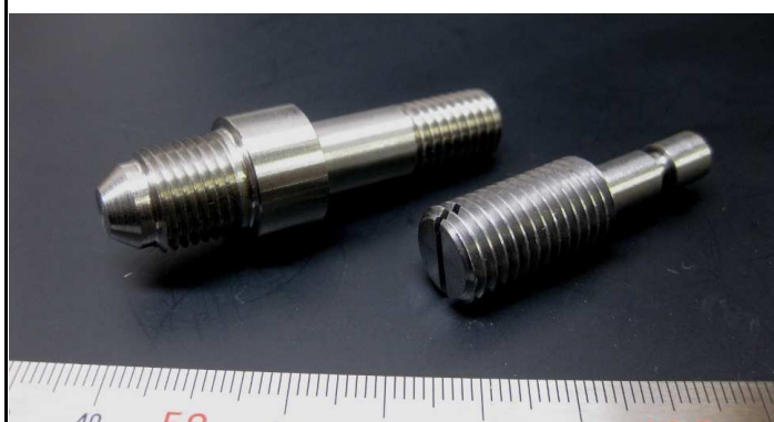
製品番号: SS12M03659NZS SUS303 左寸法: 全長: 55 径: \phi ①16 ②10 ③M13-10 右寸法: 全長: 42.5 径: \phi ①M12 ②7 ③4
