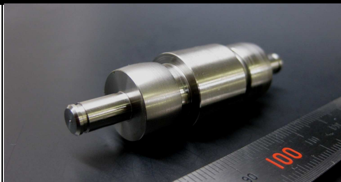
製品番号: SS12M40362LNS SUS303 寸法: 全長: 63.2 径: \phi ①18 ②16 ③13
